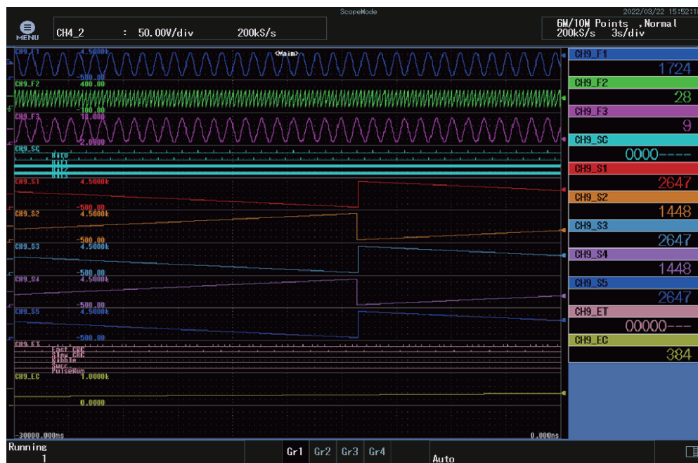
横河DL950示波记录器sent总线监测图
