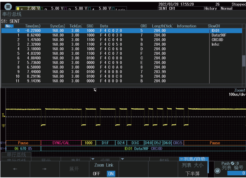
横河DLM3054示波器sent总线解码图、列表和波形可同时显示
