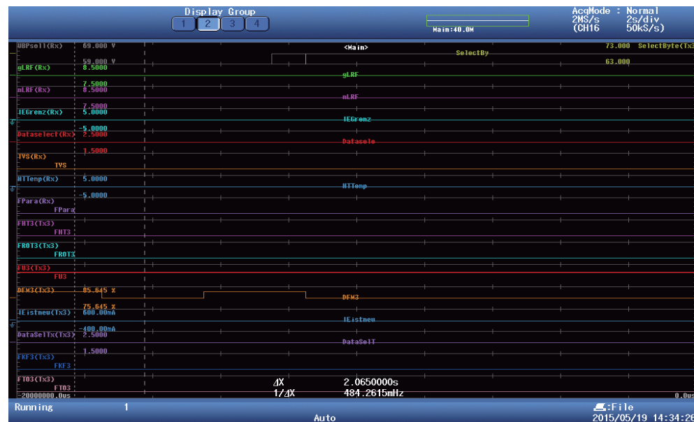
横河DL950示波记录仪的LIN总线监视图
